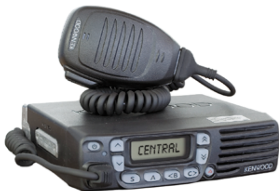
TK7160HK (Versión VHF) con módem integrado para gps
